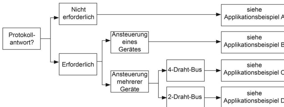
Soll das Gerät keine Protokollantwort senden (Normalfall), gilt Applikationsbeispiel A für die Ansteuerung eines oder mehrerer Geräte.
