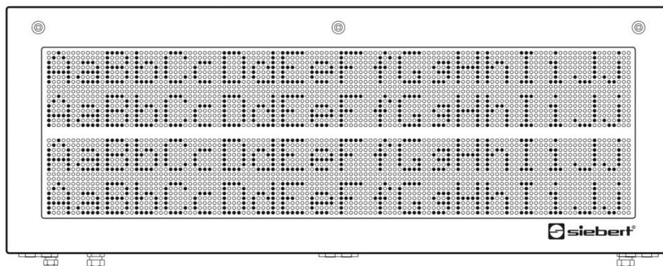
Der mechanische Abstand der Matrixmodule entspricht der Höhe von 2 Pixel. Damit ist der Zeilenabstand zwischen erster und zweiter Zeile der gleiche wie zwischen zweiter und dritter Zeile.
